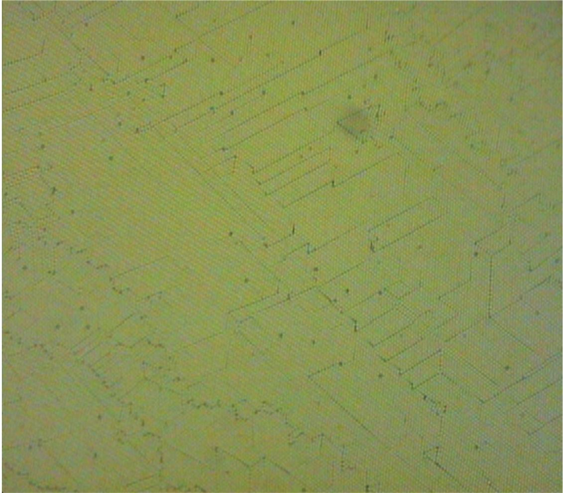
Figura A.1: Imagem do arranjo de esferas de 1000 nm ao microscópio ótico.
