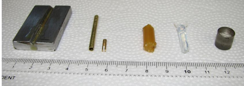
Figura B.2: Foto de alguns materiais usados na preparação de amostras. Da esquerda para a direita: suporte para serra de diamante, canudo de latão com encaixe para amostra, cera amarela, cera transparente e suporte transparente para amostra.
