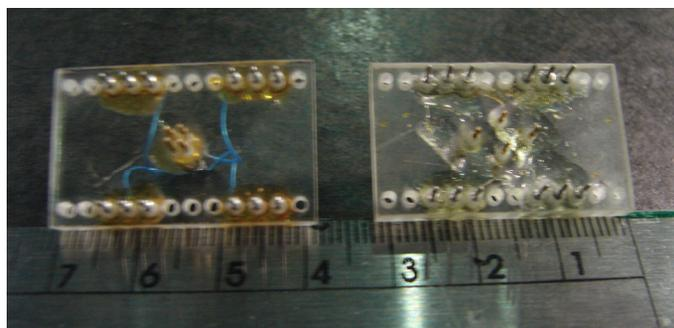
Figura 5.10: Foto com dois tipos de cabeças de contato produzidas para o magnetômetro EHE.
