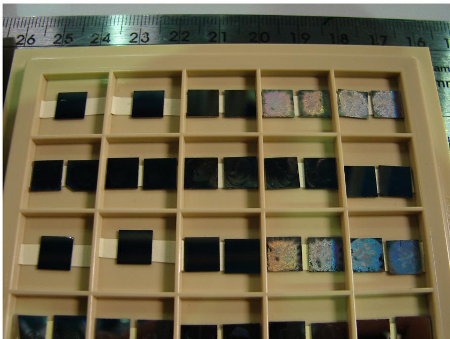
Figura A.2: Foto dos substratos produzidos. É possível ver o colorido provocado pela difração da luz na rede de esferas.
