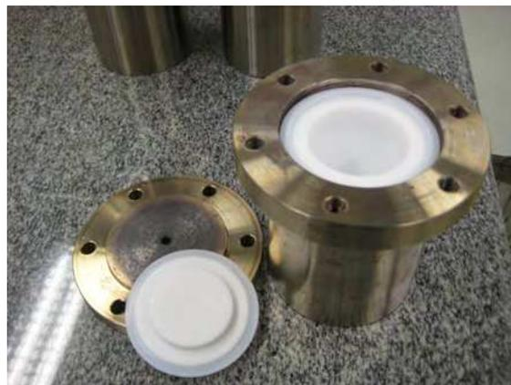
**Figura 4.5** – Autoclave desenvolvida para reação hidrotérmica
