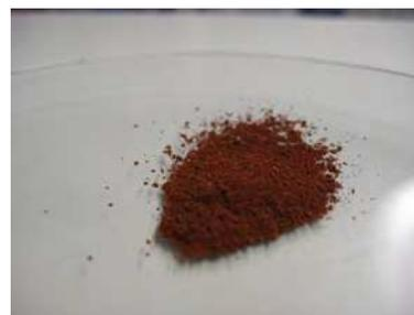
**Figura 4.8** – Partículas de maghemita ( $\gamma\text{-Fe}_2\text{O}_3$ ).
