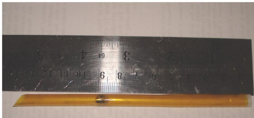
**Figura C.1:** Nesta foto pode-se observar a amostra em pó presa ao porta amostra por fita de kapton.
