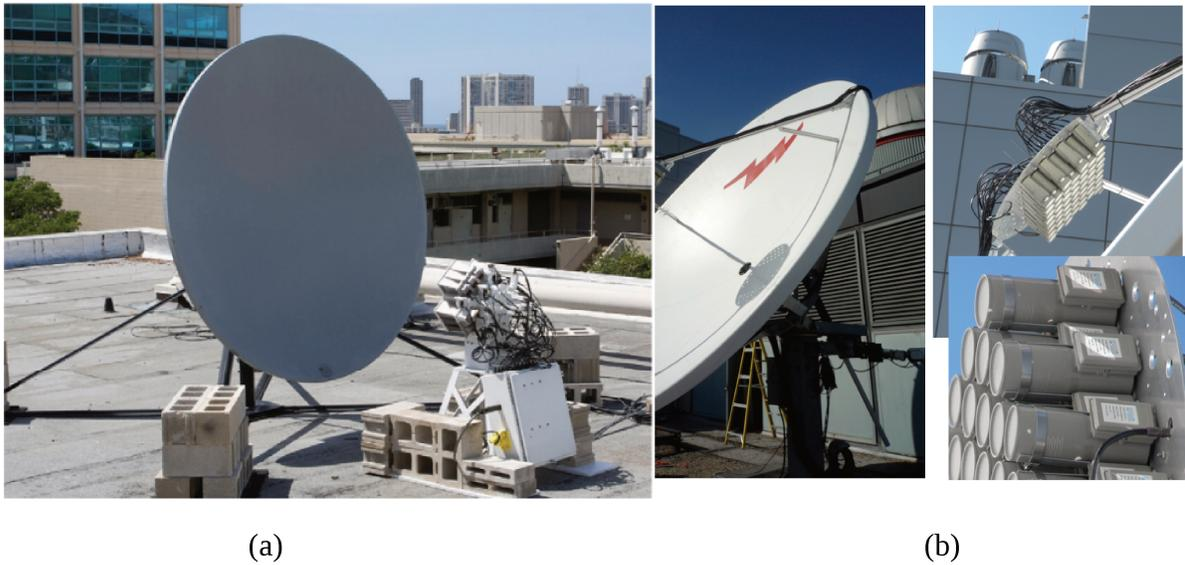
**Figura 3.28:** (a) Detector AMBER formado por seu disco refletor e uma câmera de *pixel* na faixa de GHz. (b) Detector MIDAS com disco parabólico refletor e uma câmera de 53 canais montada sob o foco principal. Figuras retiradas de [32] [33].
