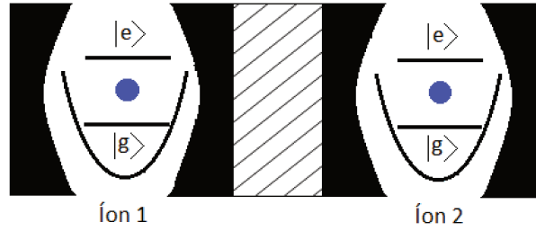
Figura 3.1.1: Esquema do sistema composto por duas cavidades acopladas diretamente com íon aprisionados em seu interior onde a região entre as cavidades é um meio dielétrico
