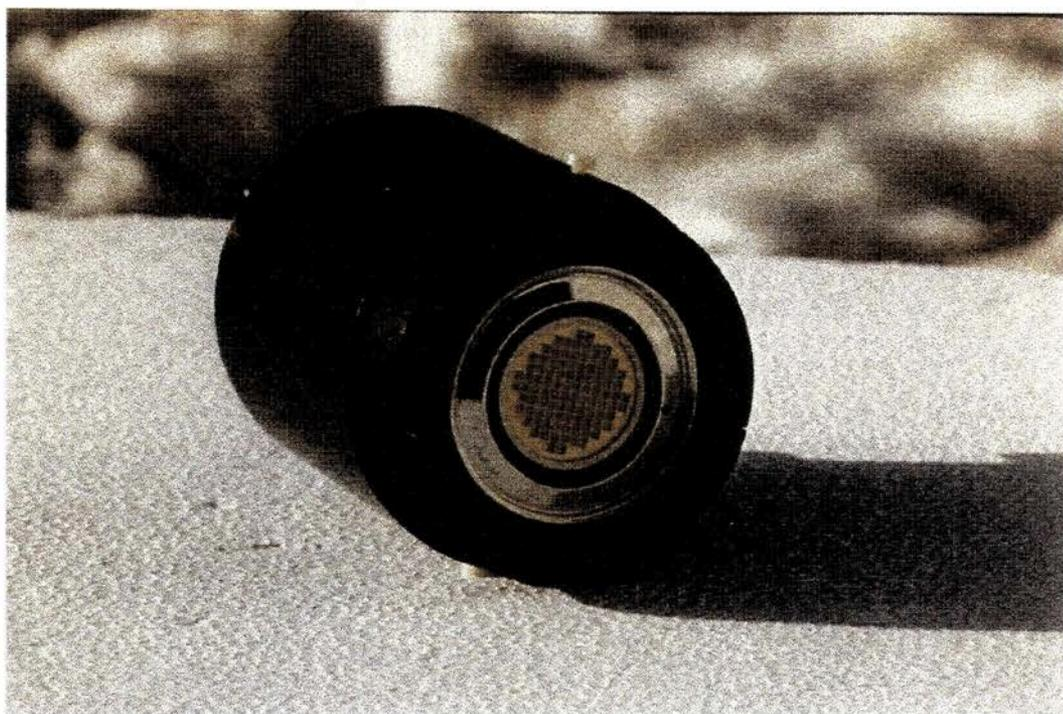
Figura 3.8: Fotomultiplicadora Philips modelo XP1704. Pode-se ver a matriz de *pixels* que forma o fotocátodo.
