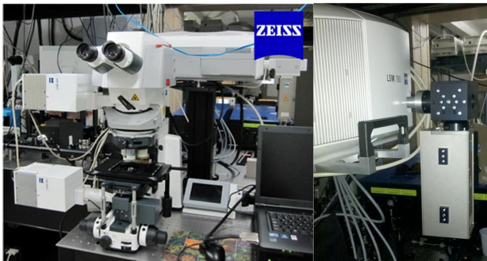
**Figura 16** Esquerda: Microscópio Confocal Zeiss LSM 780. Direita: adaptação para detecção descanned.
