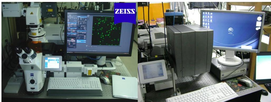
**Figura 13** Esquerda: Microscópio Confocal Zeiss LSM 780. Direita: Pinça Óptica acoplada
