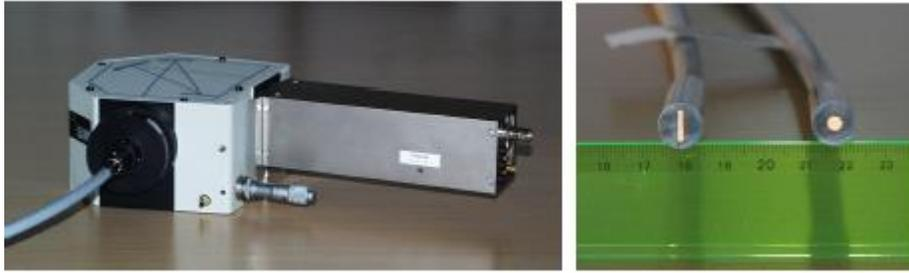
**Figura 53** Esquerda: foto do detector multiespectral. Direita: foto da fibra de acoplamento mostrando a ponta retangular e a outra ponta circular.
