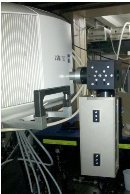
**Figura 88** Detector de FLIM acoplado a saída externa do scanner
