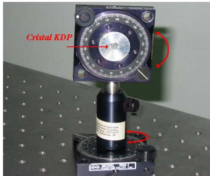
FIG. 2-11 Sistema usado para encontrar o ângulo de incidência ideal. O controle superior regula o ângulo polar e o inferior, o ângulo azimutal.
