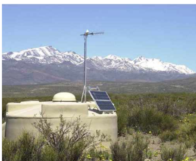
Fig. 1.3: Um tanque instrumentado do arranjo de superfície operando no sítio sul do Observatório Pierre Auger.
