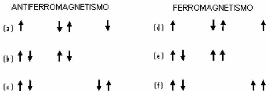
**Figura 2.8:** Desenho esquemático da interação de supertroca em um óxido magnético. As setas indicam os spins dos elétrons e diferentes possíveis distribuições desses elétrons nos metais de transição (M) e no oxigênio (O).
