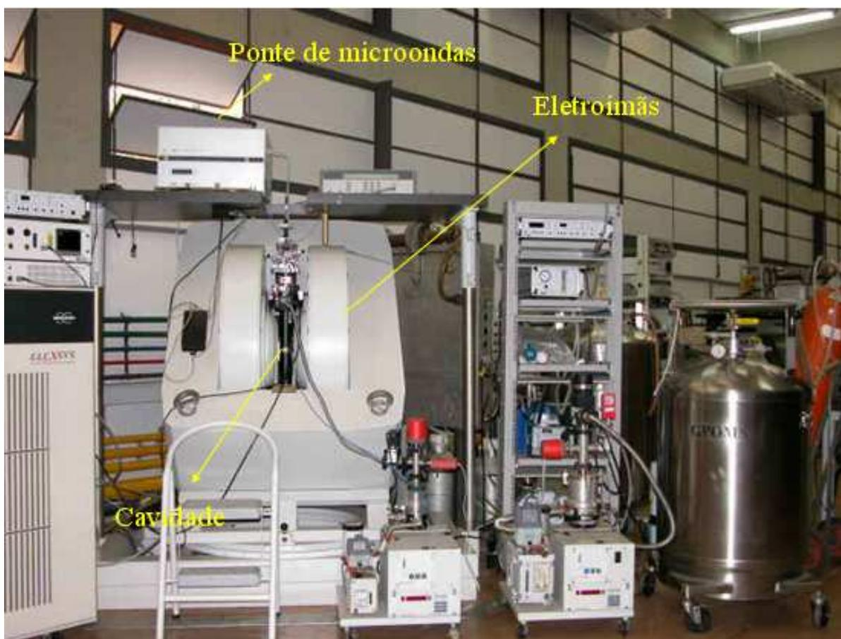
**Figura 3.4:** Um típico espectrômetro de EPR.
