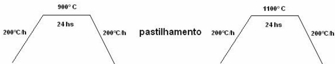
**Figura 3.1:** Processo de síntese e pastilhamento das amostras  $\text{Ca}_{2-x}\text{La}_x\text{FeIrO}_6$  e  $\text{Sr}_{2-x}\text{La}_x\text{FeIrO}_6$ .
