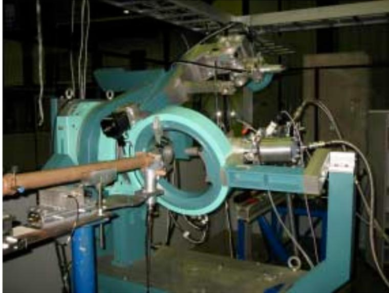
Figura 4.6. Foto do difratômetro de seis círculos.
