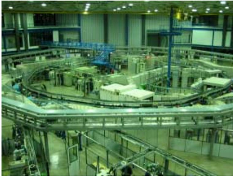
Figura 4.1. Foto do Anel de Armazenamento de elétrons, onde se percebe o Booster formando um acelerador elíptico. As linhas de luz se encontram do lado externo a parede de concreto.
