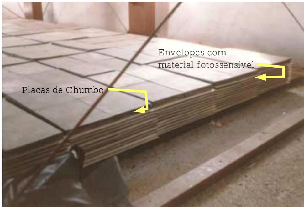
Figura 2.3: Foto dos blocos de uma câmara inferior. Notar o arranjo tipo "pilha" de placas de Pb e envelopes (contendo material fotossensível) que é usado para formar um bloco. Ao fundo pode ser vista parte da estrutura metálica usada para sustentar o alvo de carbono e a câmara superior, que não aparecem na foto.
