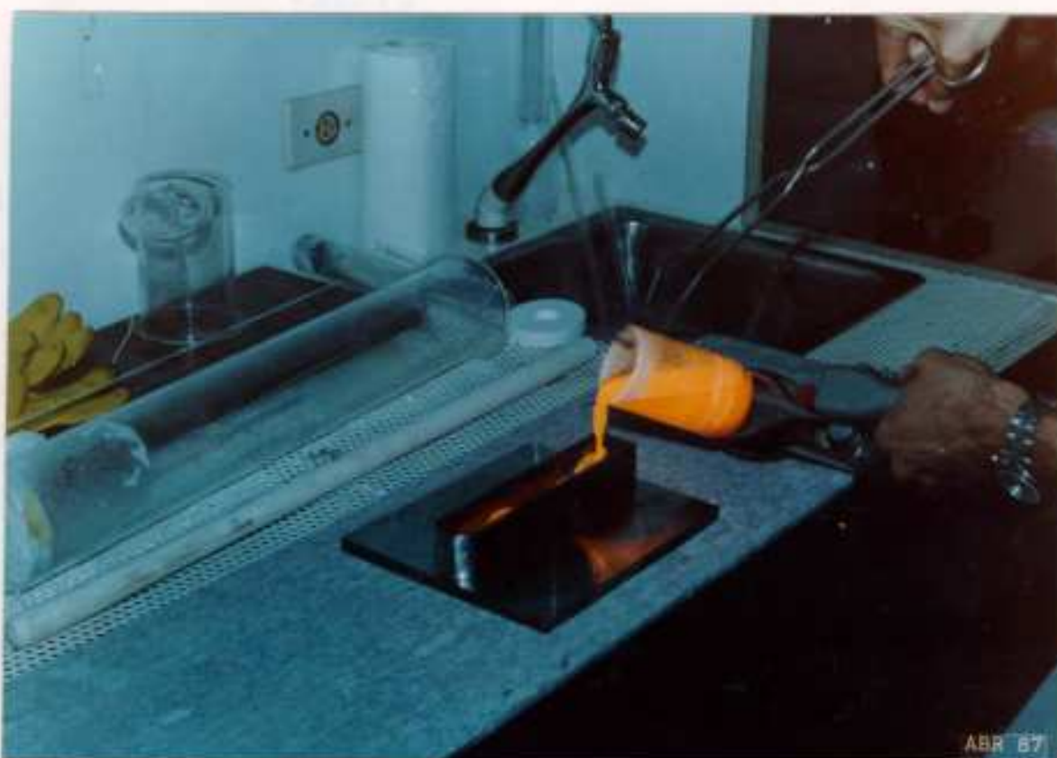
Fig. 19 - Transferência do vidro fundido para um molde de aço.
