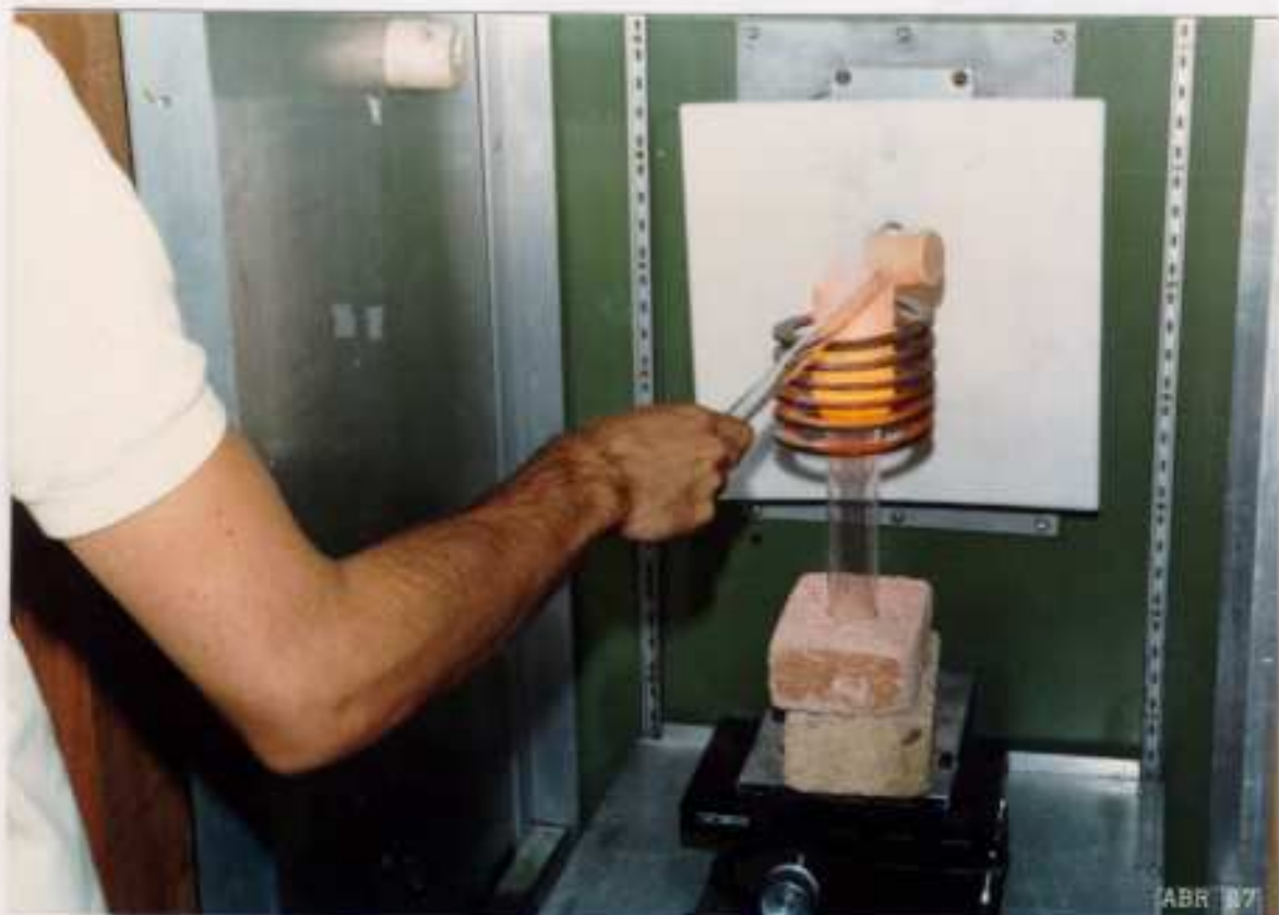
Fig. 18 - Alimentação do cadinho durante a fusão
