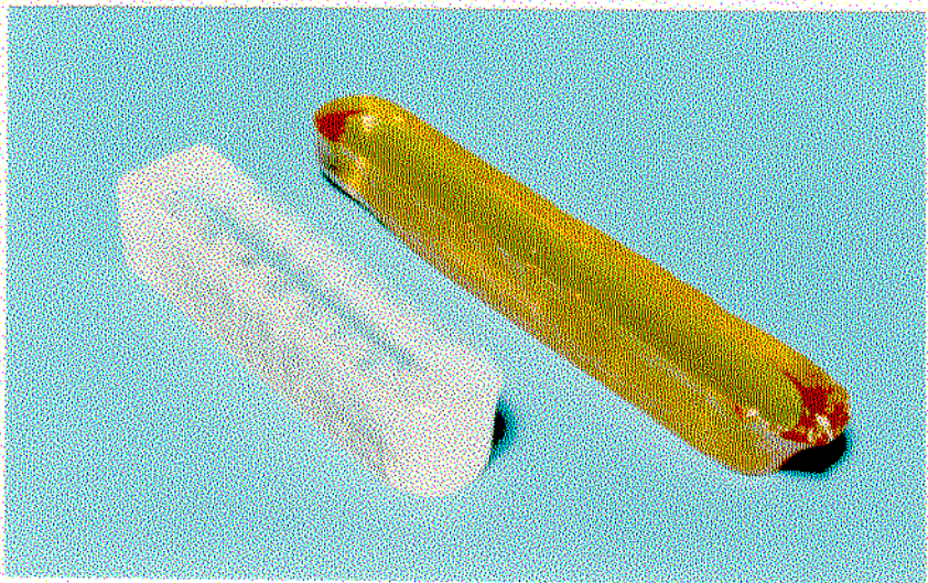
Fig.37 - Vidro "C" fundido em cadinho de quartzo (transparente) e de mulite (amarelo).
