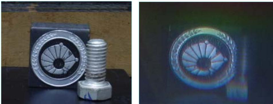
Fig. 3.9 Esquerda: Fotografia de dois objetos extensos. Direita: Imagem dos objetos.
