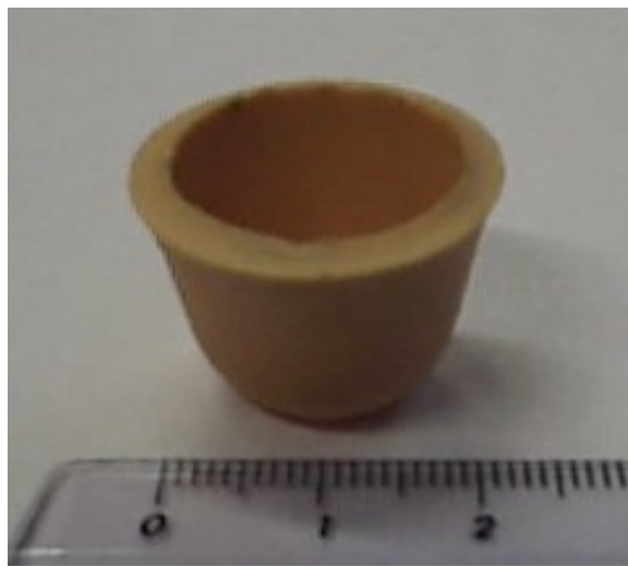
Figura 14. Cadinho de Sm 2 O 3 produzido durante o trabalho.
