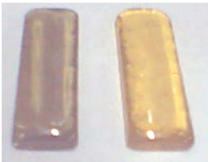
**Figura 3.1.** Foto dos vidros, depois da fusão, a esquerda, sem  $\text{O}_2$  e a direita, com  $\text{O}_2$ .
