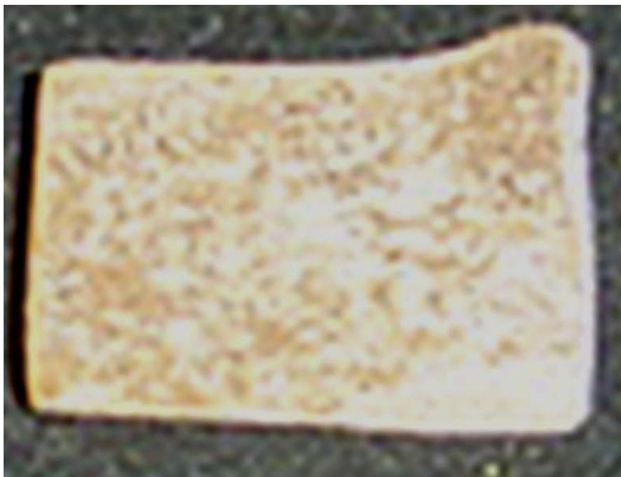
**Figura. 3.24.** Superfície do vidro TEGNAZO10, onde podemos ver a deformação à simples vista do vidro.
