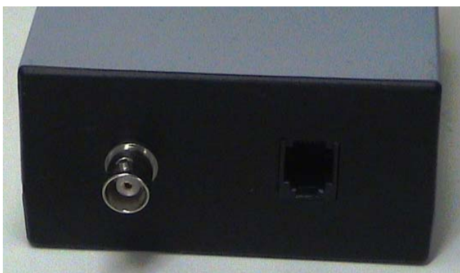
Figura 4.33 Saída BNC do sinal proporcional a diferença das fotocorrentes e conector para o fotodetector.
