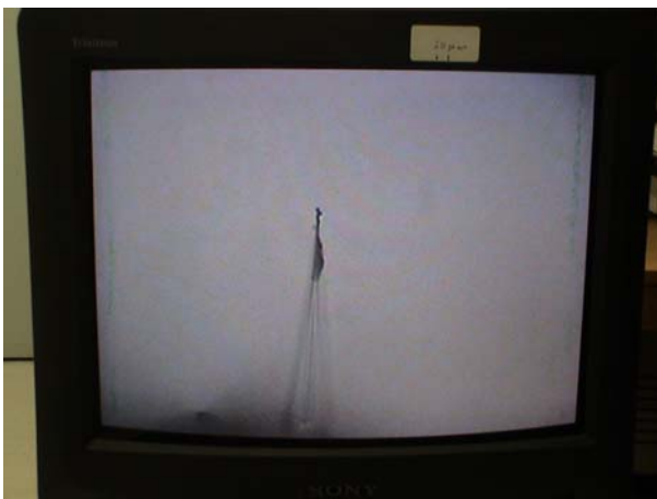
Figura 4.16 Cantilever visto lateralmente na tela da TV após aumento de 100x do microscópio
