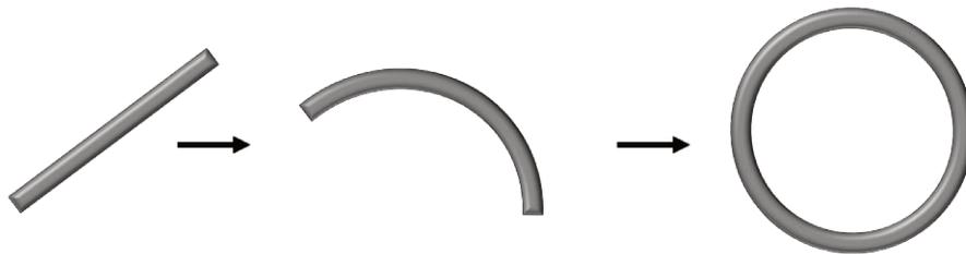
*Fig. 2.1. Vista superior de um ressonador em anel formado a partir de um guia de onda retangular.*
