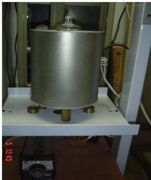
Fig. 35 Esquema representativo do forno vertical de resistência elétrica no lado esquerdo e imagem real no lado direito, com controle de temperatura entre 100 e 1000°C.
