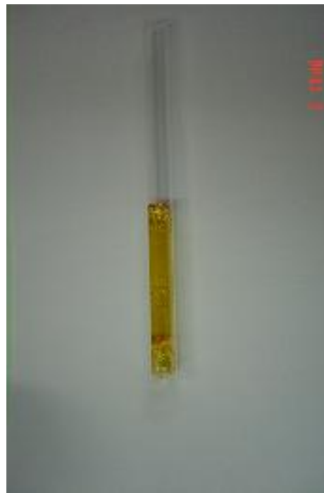
Fig. 47 Vidro telurito em forma de barra, que se encontra dentro de um tubo de sílica.
