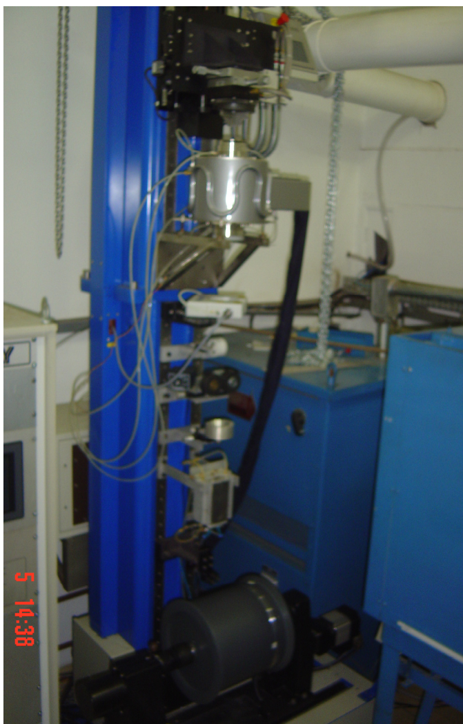
Torre de puxamento de 4m de altura
