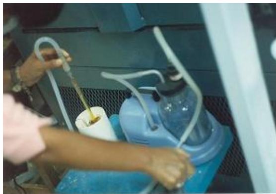
Fig. 44 Fabricação de tubo/barra de vidro telurito pelo método de sucção em fase líquida com ajuda de uma bomba mecânica [73].
