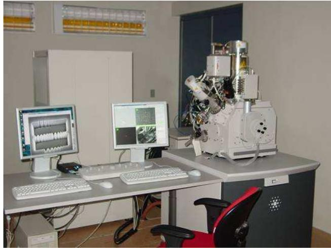
**Figura 3.9** Sistema *Dual-Beam system* FEI modelo NOVA 200 Nanolab da FEI Co.
