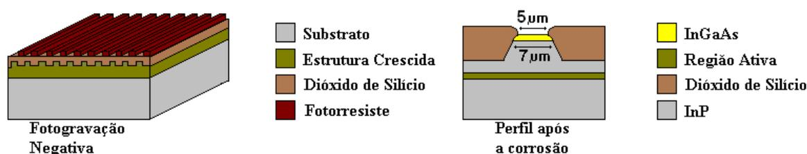
**Figura 7.4** - Fotogravação negativa. Ao lado, o perfil de camadas após a corrosão das partes expostas de  $\text{SiO}_2$ . Fotorresiste 5212. Revelador MF312
