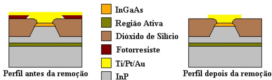
**Figura 7.5** - Representação do processo de metalização do "lado p". Ao lado, perfil de camadas após a remoção do fotorresiste. Fotorresiste 5214. Revelador AZ400
