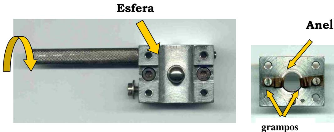
**Figura 3-2** – Fotografia da célula de pressão biaxial. Lado esquerdo, mostra a esfera e uma barra fina que gira para deslocar a esfera. Do lado direito, mostra o suporte de amostra onde contém o anel e os grampos para prender a amostra.
