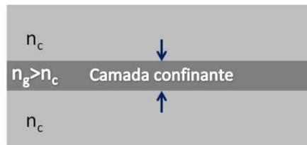
**Figura 1:** Esquema de estrutura de camadas epitaxiais para confinamento óptico transversal.
