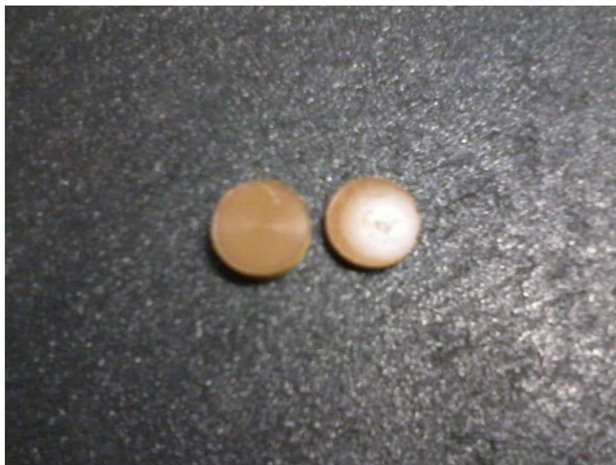
Figura 5.11: Foto da amostra não tratada (esquerda) e da amostra tratada (direita) durante 4 h.
