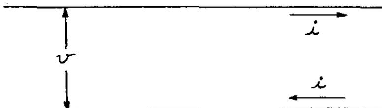
Fig. 19 - Conversão de sinal para voltagem e corrente em uma linha de transmissão.
