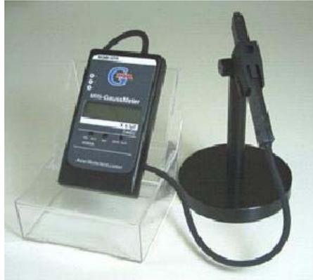
Figura 2.8 – Miligaussímetro com precisão de 0,1 miligauss [54].
