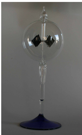
Figura 1.1: Réplica do radiômetro de William Crookes. 1
