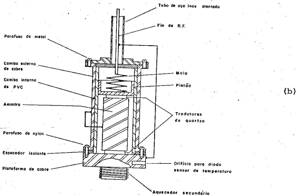
Fig. II - 6 :: Suportes de amostra para ultrassom. a) ondas perpendiculares ao campo; b) ondas paralelas ao campo.
