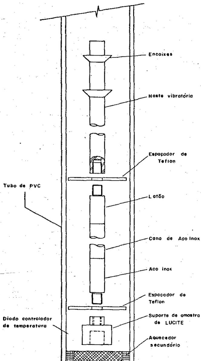
Fig. II - 3 : Suporte de amostra para o magnetômetro.
