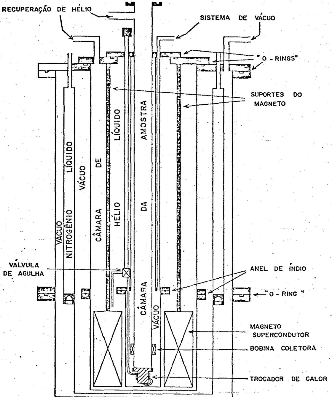
Fig. II - 1:0 sistema criogênico (segundo Torikachvili, /20/)
