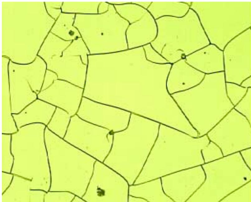
Figura 3.16: Micrografia do filme de polímero sobre vidro após vácuo. A área total é de  $790 \times 590 \mu\text{m}^2$ .
