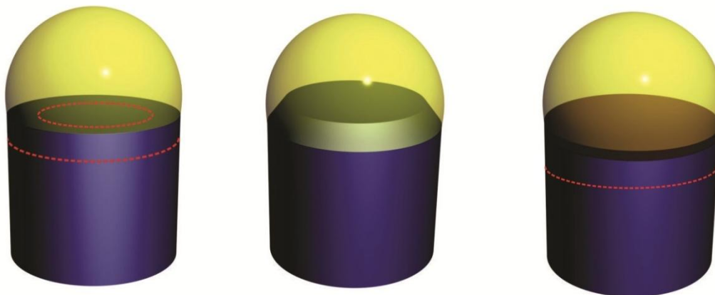
Figura 2.6. Quando ocorre uma nucleação, a região ao redor da TPL é dissolvida. Em seguida, conforme a supersaturação da nanopartícula aumenta, a região é novamente preenchida. Quando a supersaturação atinge um valor limite, acontece a nucleação e formação de uma nova monocamada.
