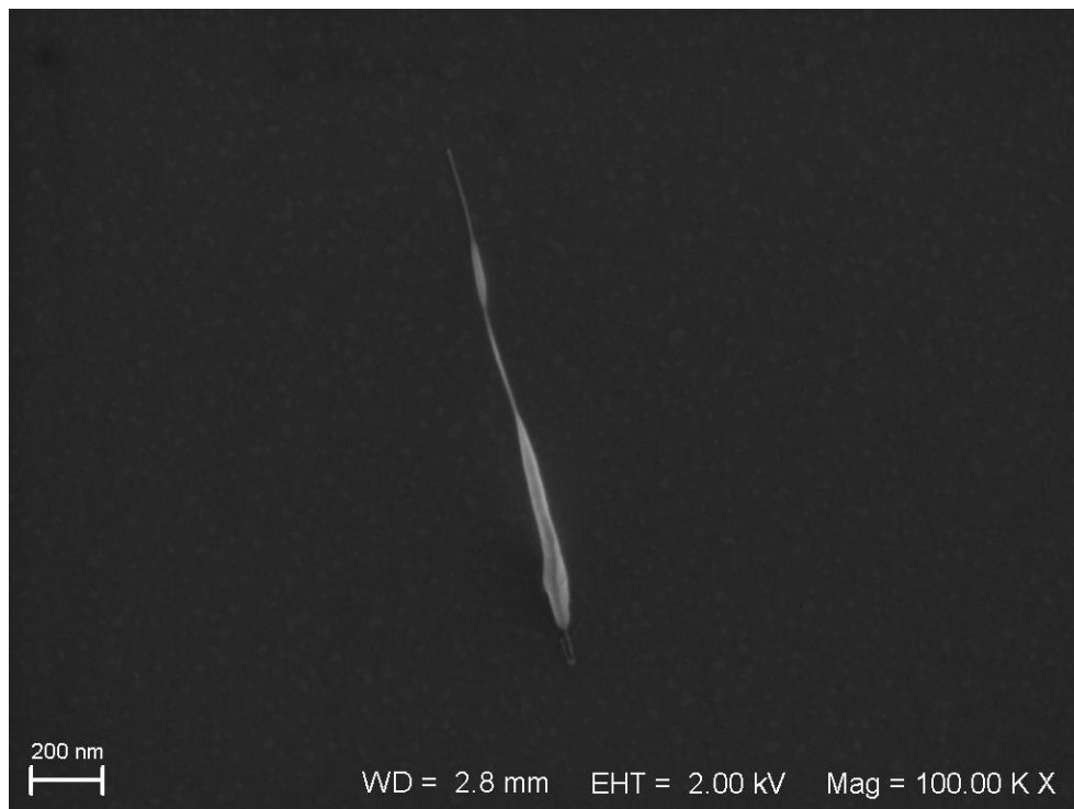
Figura 3.7. Imagem por SEM de um nanofio da amostra C4.
