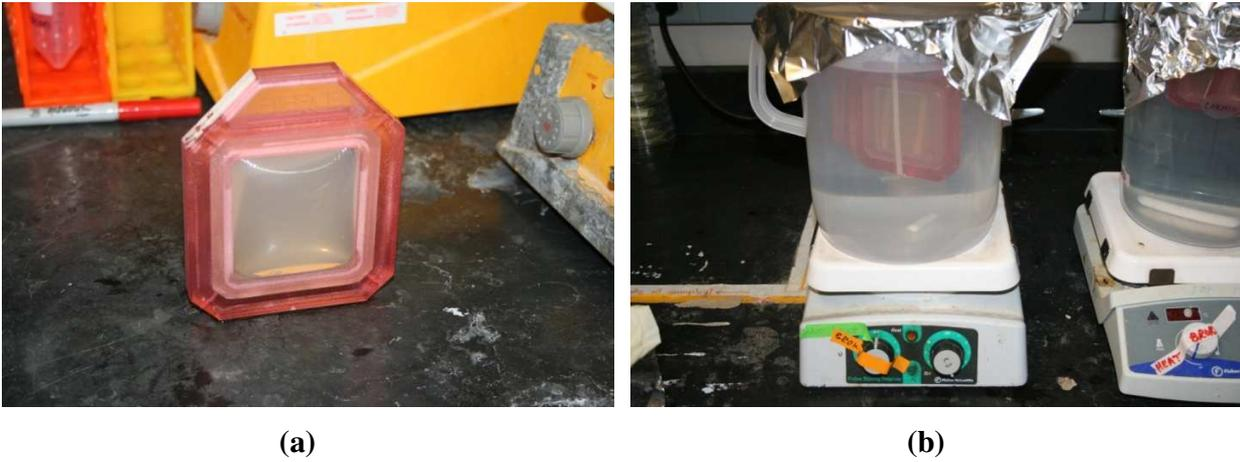
Figura 5.8 (a) Cassete de diálise preenchido com solução de seda. (b) Cassete de diálise inserido em um béquer com água deionizada para realização da filtração.
