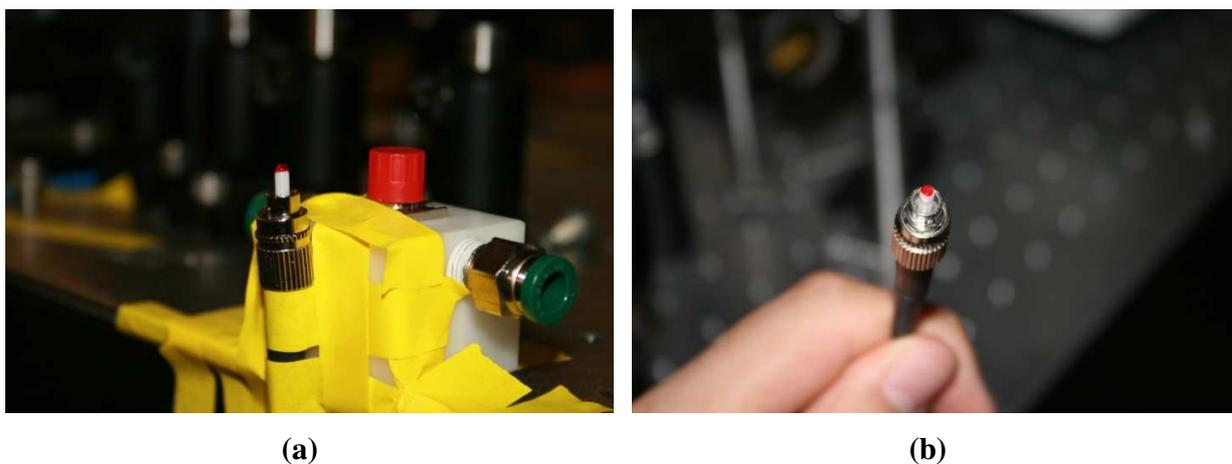
Figura 5.13 (a) Gota da solução de seda dopada com hemoglobina depositada sobre a ponta da fibra óptica. (b) Extremidade da fibra óptica depois da secagem.
