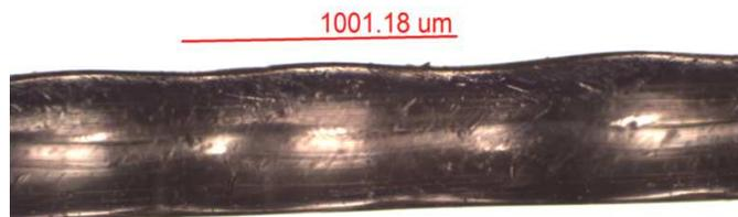
Figura 3.16 Microscopia da lateral de uma fibra óptica polimérica após a incidência do laser de CO<sub>2</sub> (aumento 4x).
