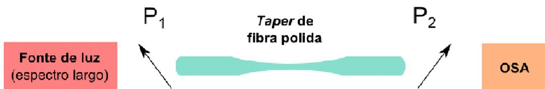
Figura 2.9 Esquema do experimento para a medida da birrefringência de grupo.  $P_1$  identifica o primeiro polarizador e  $P_2$  o segundo polarizador. OSA: *optical spectrum analyzer* (analisador de espectro óptico).
