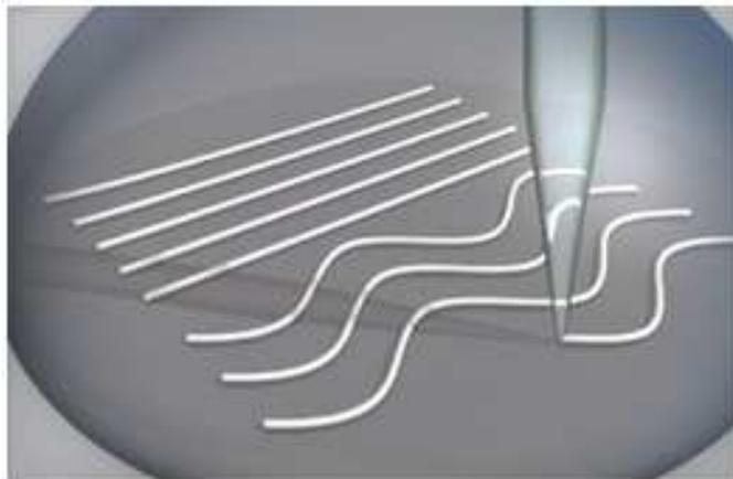
Figura 5.4 Ilustração da fabricação de guias de onda a partir da solução de seda (extraído de [50])
