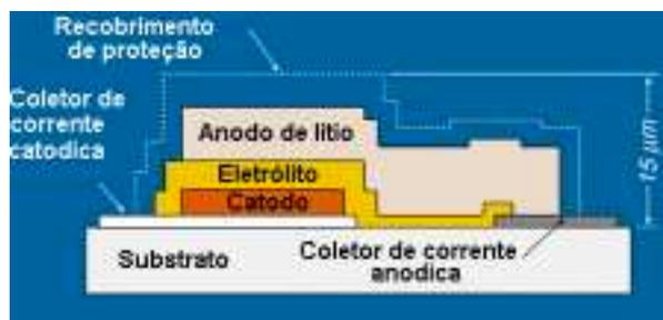
**Figura I.5:** Esquema de uma seção transversal de uma microbateria<sup>15</sup>.
