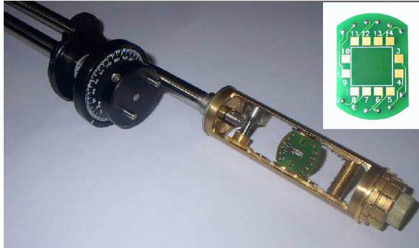
Figura H.1: Suporte de amostra para medidas de transporte no PPMS.
