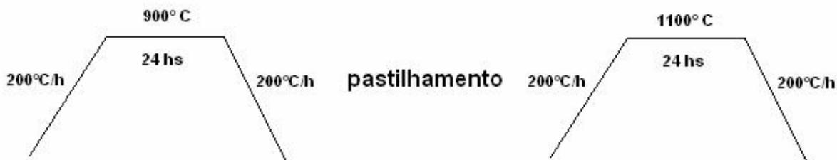
**Figura 4.2:** Processo de síntese e pastilhamento das amostras  $\text{Ca}_{2-x}\text{La}_x\text{FeIrO}_6$ .
