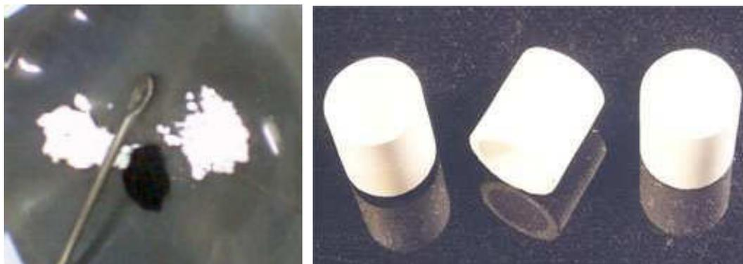
**Figura 4.1:** Processo de mistura do material e exemplos de cadinhos utilizados para o aquecimento da amostra.
