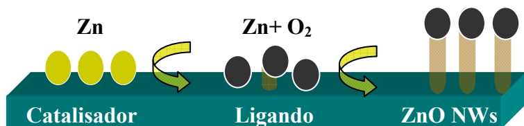
Figura 3.2 - Esquema do crescimento dos nanofios por Vapor-Liquid-Solid.
