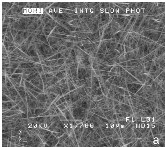
Figura 5.33 - a) Imagem de SEM dos nanofios de ZnO antes da adição do érbio. b) Com aumento maior.
