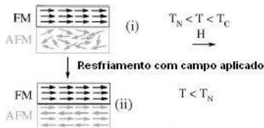
*Figura 2.7* – Representação do alinhamento da camada AFM; (i) resfriar a uma temperatura intermediária e (ii) aplicar um campo e resfriar todo o sistema até a temperatura desejada.
