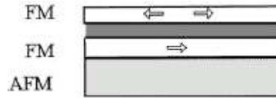
Fig. 2.6 – Diagrama esquemático de uma válvula de spin onde uma camada FM tem a sua magnetização livre e a outra é fixada pela interface AFM.
