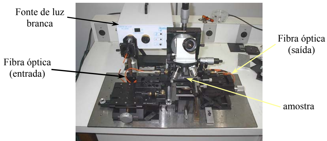
Figura 1 – Montagem experimental utilizada nas tentativas de medida do PBG para as estruturas bidimensionais fabricadas.
