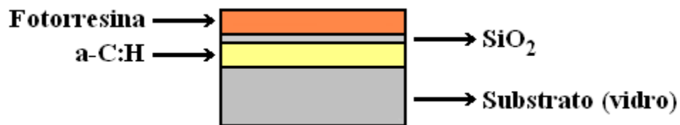
Figura 4.13 – Esquema da disposição dos filmes de a-C:H, SiO 2 e fotorresina sobre o substrato para utilização no processo de litografia.
