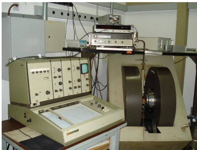
Figura 3.8: Espectrômetro de Ressonância Eletrônica de Spin, Varian E-12.
