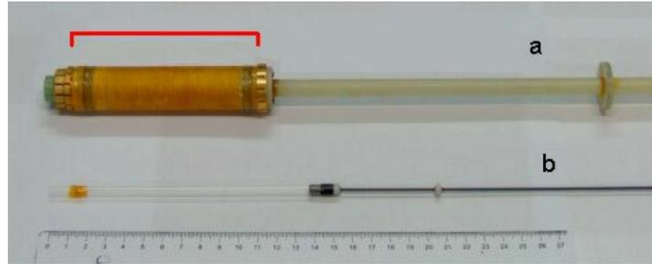
Figura A.4: (a) Sonda magnetométrica, na qual a amostra é introduzida e (b) haste que suporta o canudo com a amostra.
