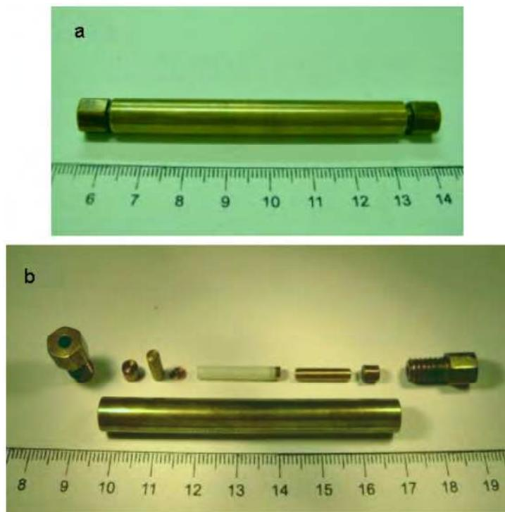
Figura 4.13 - Fotografia da célula de pressão usada nas medidas de magnetização com pressão aplicada [77].
