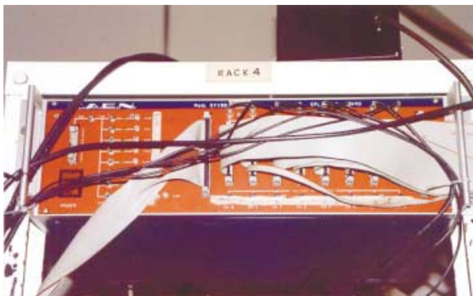
Figura 7: Fotografia da Splitter Board CAEN modelo SY190 com os 8 canais usados para a transmissão dos dados.
