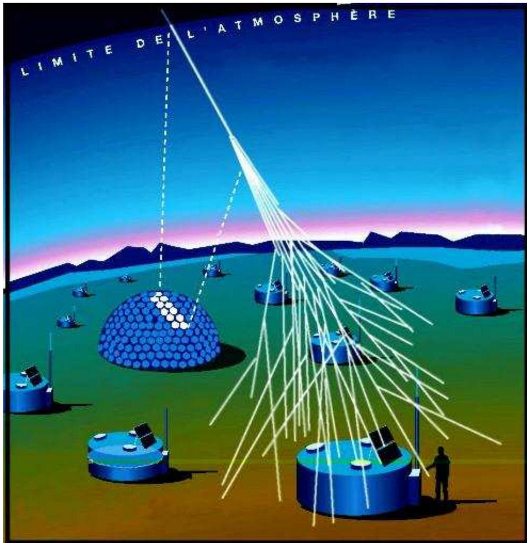
Figura 2.2: *Esquema ilustrativo de como serão dispostos os tanques Cherenkov e os prédios dos telescópios de fluorescência no OPA. Créditos: Colaboração Pierre Auger - <http://www.auger.org/>.*
