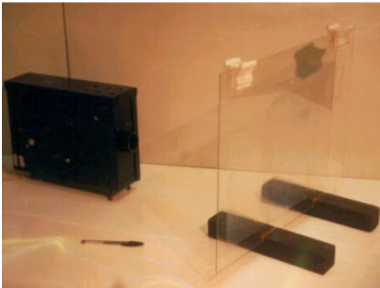
Fig. A2.9 Holoprojetor: Aparelho que utiliza as propriedades da tela holográfica, para a reprodução das imagens tridimensionais ou holoimagens.
