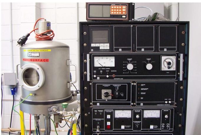
Figura B.1: Sistema de “E-Beam” utilizado para os processos de evaporação.
