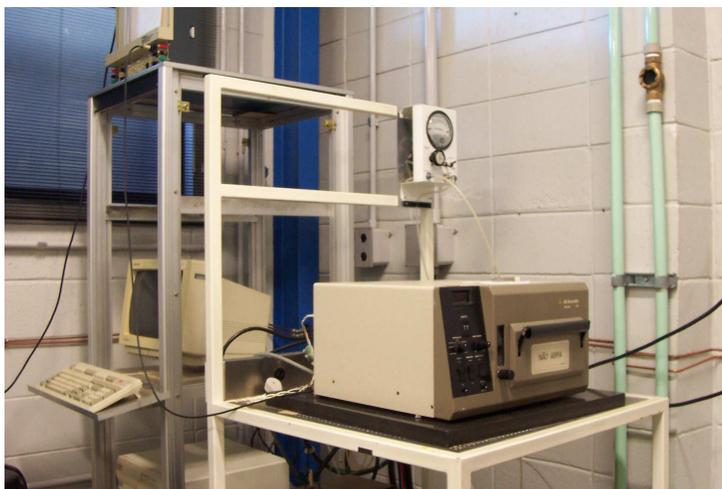
Figura A.1: Sistema de “Rapid Thermal Annealing” utilizado para realizar os contatos ôhmicos.
