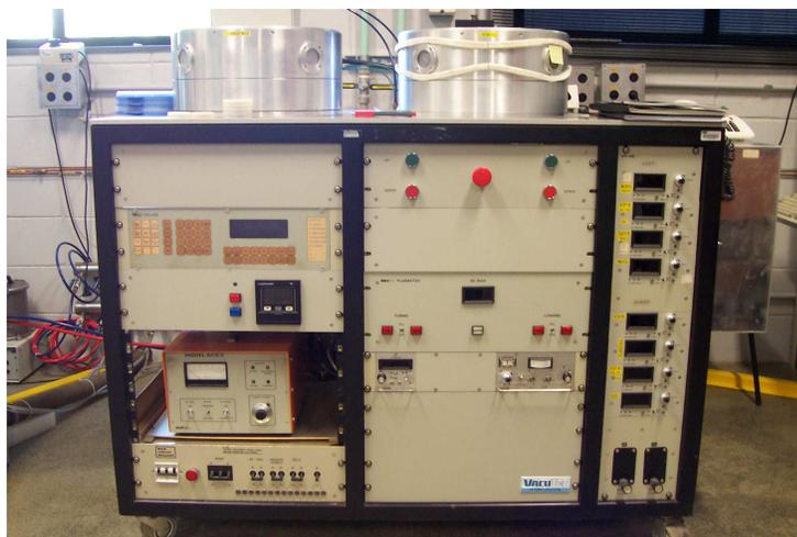
Figura A.3: Sistema de “Reactive Ion Etching”.
