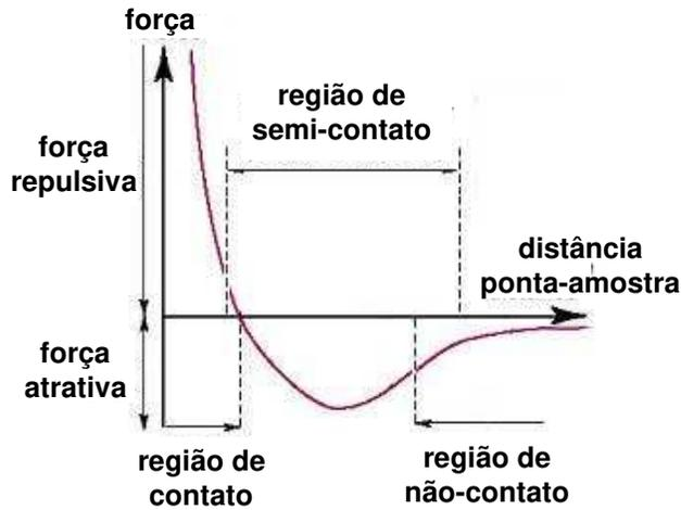
Figura 2.3: Diferentes regiões de força experimentadas pela ponta em cada um dos modos de operação do AFM.
