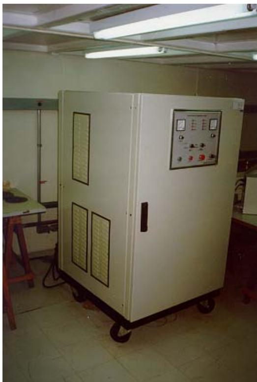
Figura A.3: Fonte de potência para o arco elétrico.
