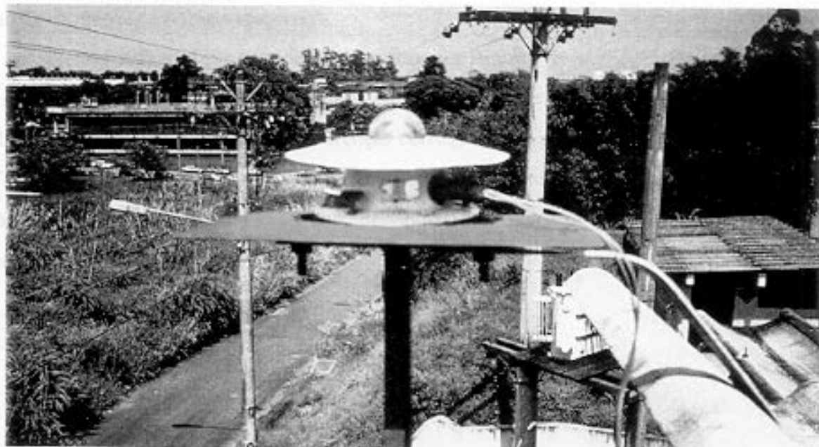
Fig. 5.2 Fotografia que mostra a instalação do Eppley para medição da radiação solar em Campinas.
