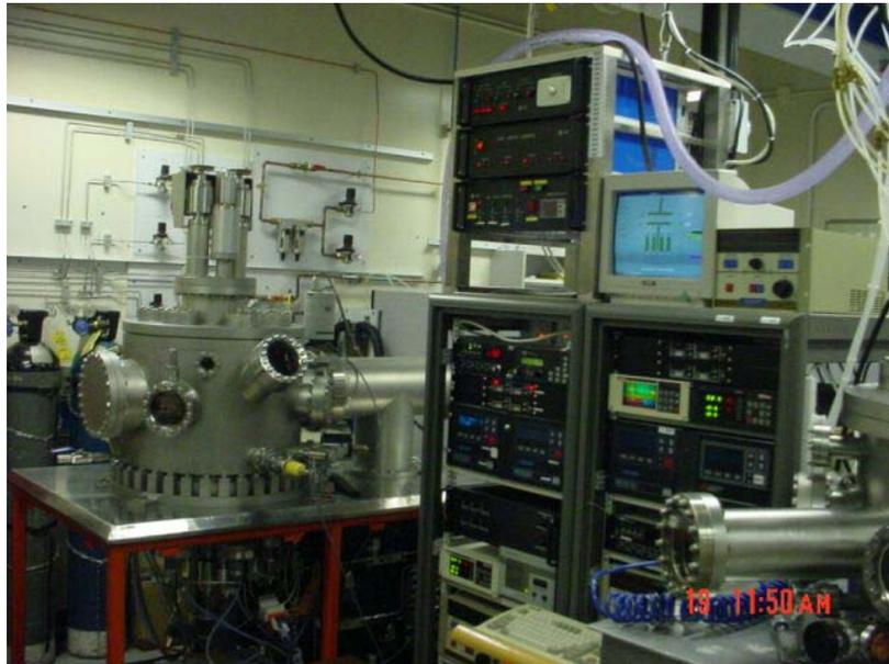
Figura 2.1. Foto do sistema de magnetron sputtering montado na UST em Hong Kong.
