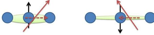
Figura 4.7: *Deformações geradas na rede devido a orientação de spin (preto). Ao inverter o spin, a componente x do dipolo elétrico (linha vermelha tracejada) é invertida, pois a relaxação do spin altera a forma da rede. Pode ser observado que o spin e o dipolo elétrico não coincidem, mas o spin tem um único dipolo elétrico como primeiro vizinho.*
