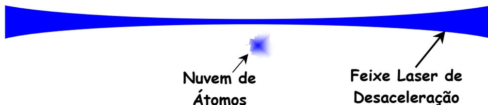
Fig. 4.3.9 Esquema da focalização do feixe laser de desaceleração para o aprisionamento e desaceleração com feixes de mesma frequência. Nessa situação, o centro do MOT se localiza dentro da extensão transversal do feixe atômico.
