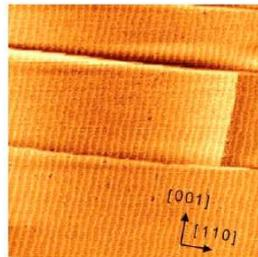
Figura 1.3: Imagem de STM mostrando os fios de ouro formados sobre uma superfície de cobre (110), [13]. Os fios estão orientados paralelamente à direção  $[001]$  da superfície.
