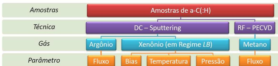
Figura 2.9 – Organograma representando, de maneira esquemática, as séries de amostras depositadas e estudadas no decorrer deste trabalho. Por tal representação enfatizamos o tipo de filme depositado, a técnica e os gases empregados, assim como os parâmetros variados. LB significa livre de bombeamento.
