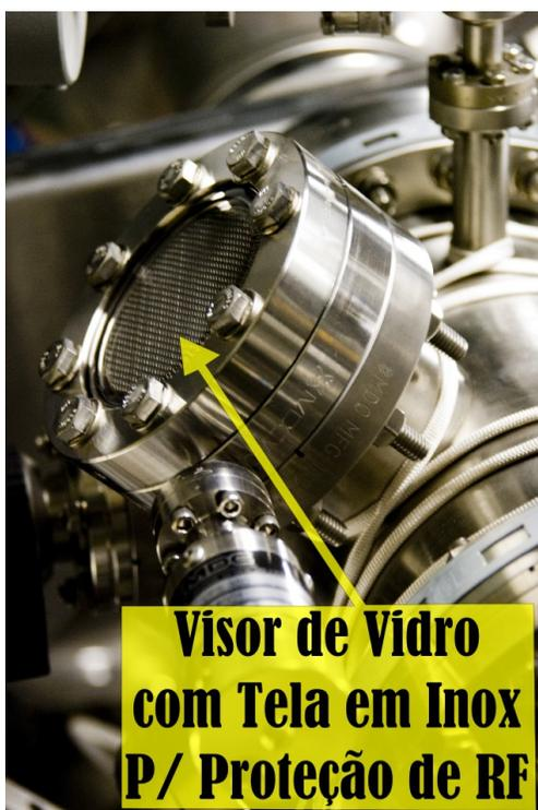
Figura 2.7 – Janela de vidro corning para acompanhamento visual do processo de formação de plasma com tela de inox 304 para quando operamos com fontes de radio frequência (13.5 MHz).
